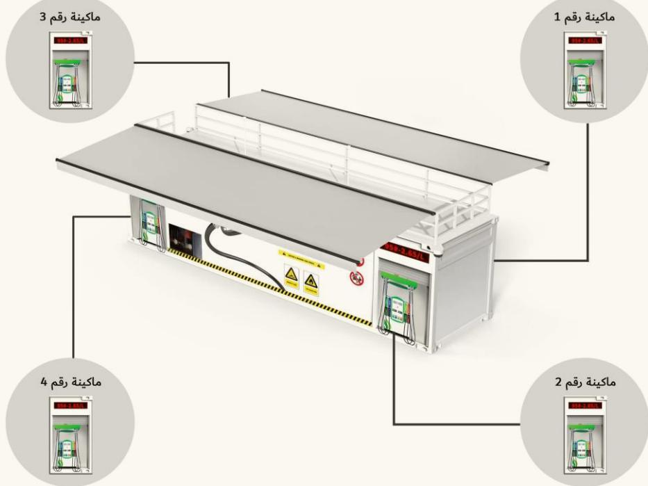
هذا المنتج يوفر جهتين خدمة و 4 ماكينات تعبئة وقود و 8 مسدسات تعبئة. بروتوكول الوحدة المركزية (CPU) مفتوح، ويمكنها التواصل مع نظام إدارة الدفع الإلكتروني IC كما يحتوي على خزان المياه المدمج على صمام قابل للتبديل بين وضعين، يتحكم في الاستخدام الفردي والاستخدام المزدوج ، الخزانات المستخدمة بسعة 75000 لتر.
