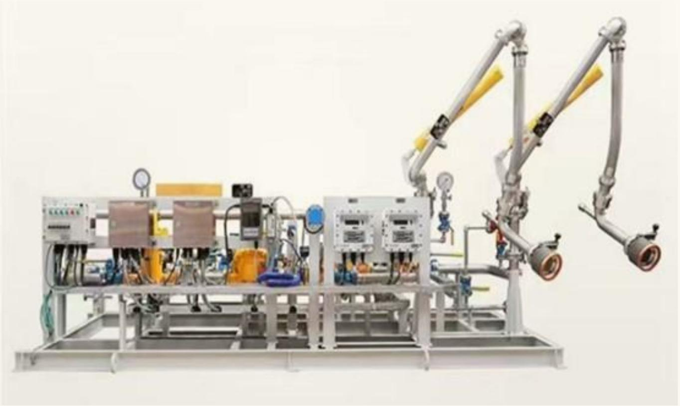
يستخدم جهاز تفريغ الزيت 3 محركات ومضخات مستقلة لتحميل وتفريغ ثلاثة أنواع من المنتجات النفطية مثل الديزل والبنزين على التوالي. ويتميز بكونه مغلقاً ومحمولاً ويتم تشغيله بواسطة أنبوب رافعة متنقلة. ويتكون من نظام الغاز ونظام التحكم. يتم تحديد تكوين جهاز التفريغ وفقاً لاحتياجات العملاء. في المناطق ذات الظروف القاسية، يلزم تبسيط التكوين قدر الإمكان لضمان استقرار المعدات.
