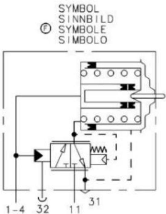
11 - إمداد الهواء      4-1 - المدخل الهيدروليكي
