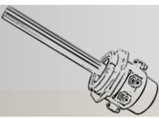
"حساس الفائض" يُستخدم بشكل رئيسي في خزانات نقل الوقود، حيث يقوم بنقل إشارة داخلية عند تجاوز الحمولة الزائدة أثناء عملية الشحن. يقوم الحساس بتنبيه منصة التحميل لإيقاف عملية الشحن، مما يضمن سلامة العملية. يشكل حساس المضاد للتدفق الزائد ومقبس التدفق الزائد و حساس التاريض معًا نظاماً مضاد للكهرباء الساكنة بشكل فعال وواقعي.
